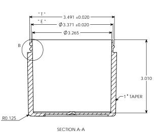
DETAIL B SCALE 2:1 NOMINAL WALL THICKNESS
